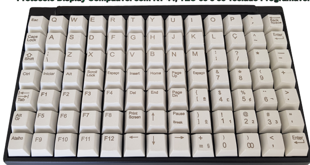
- Dimensões: Larg. 260 x Comp. 155 x Alt. 40 (mm), sem Display ou Larg. 260 x Comp. 194 x Alt. 61 (mm), com Display, Inclinação 7°
